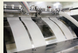
①ねり肉をシート状に成形し、スチーマーで加熱します。
