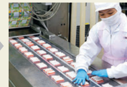
③成形されたフィルムに検品した製品を詰め、真空包装します。
