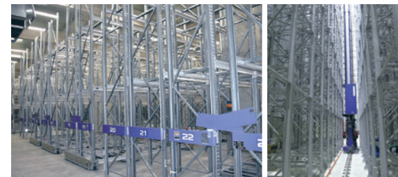
大阪舞洲2号棟。保管効率が高く、省スペースを実現する移動ラック(左)。省力化の進んだ自動倉庫(右)
