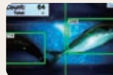
養殖魚のモニタリングシステム⇒魚体測定による生育管理
